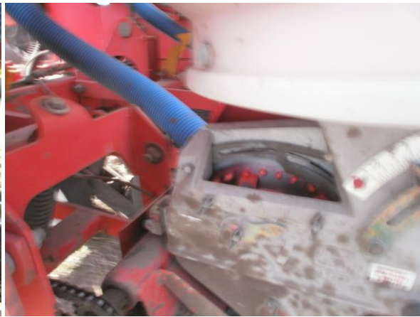
Figura 7. Carga con semillas de las celdas de los dosificadores neumáticos. a) Dosificador Nsoplado. b) Dosificador Nsucción
