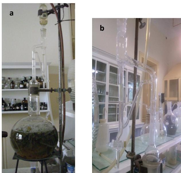
Figura 7. a) Destilador de aceites esenciales de laboratorio. b) Trampa Clevenger de vidrio para aceites esenciales de menor densidad que el agua.
