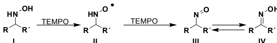
Esquema 59. Mecanismo de reacción para la oxidación de hidroxilaminas empleando TEMPO como catalizador.
