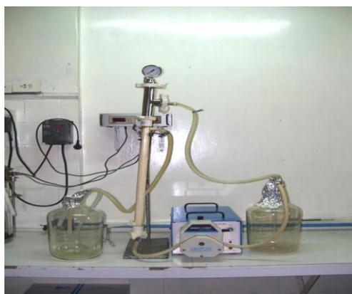
**Figura 7: Equipo para filtración tangencial.**
