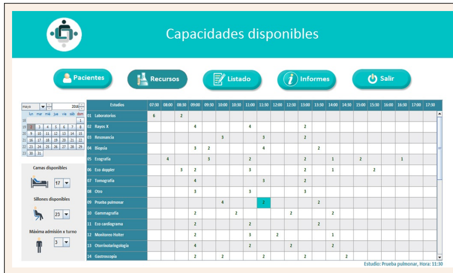
Figura 3. En la solapa Recursos se elige para cada día del calendario la disponibilidad de estudios (parámetro \mu_{b,k}^i ) de la UCM. Se listan en forma vertical los estudios de la Tabla 1 mientras que en la dirección horizontal están las divisiones de tiempo k \in K de dos bloques b \in B . Para ser más específico, las divisiones de tiempo dentro de los bloques turno mañana y tarde duran media hora. Esta tabla se encuentra cargada de antemano con valores que fueron asignados en la solapa Configuración . Además, a la izquierda se observa que se pueden elegir los valores de disponibilidad de camas y sillones (parámetros D_1 y D_2 respectivamente).
