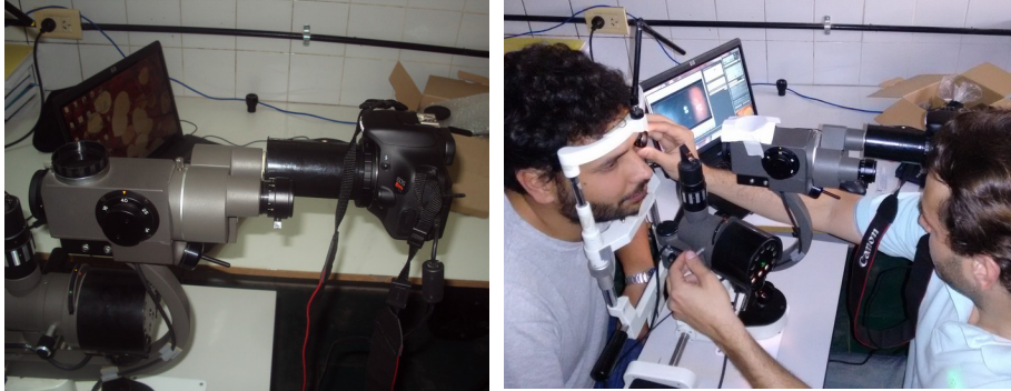
Figura 1. Lámpara de hendidura con prototipo de acople y cámara réflex.
