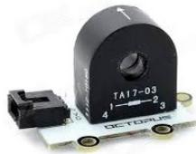
**Fig. 7.** Sensor de corriente Octopus
