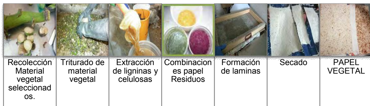
FIGURA 1. Proceso de elaboración de papel. Fuente: Autores. 2014.
