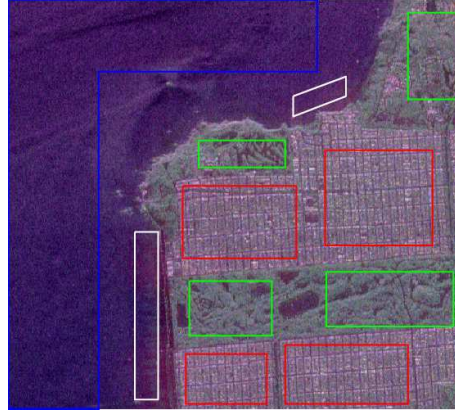
Figura 5.3: Imagen San Francisco. Rojo: |HH-VV| . Verde: |HV+VH| . Azul: |HH+VV| . Zonas de control: mar, edificado, vegetación, costa.
