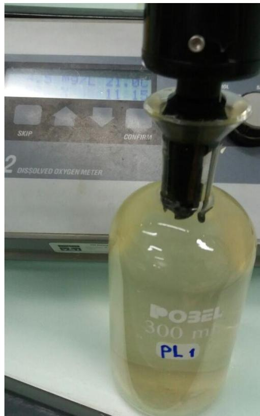
**Figura 6.2.** Medición de oxígeno con sensor YSI-52 en botellas de DBO.
