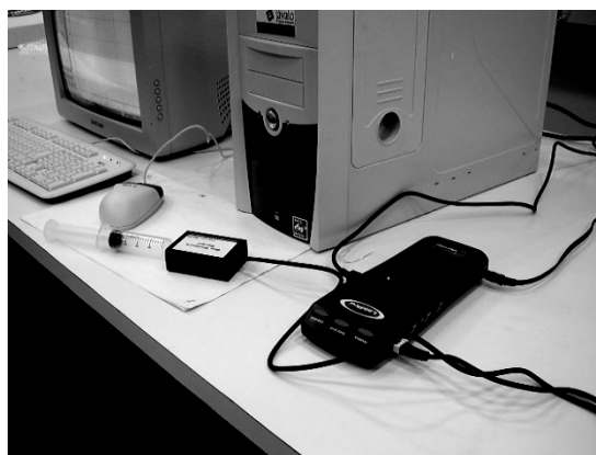
Figura 1: Aquí se observa la jeringa, el sensor de presión y la interfase conectada a la PC.
