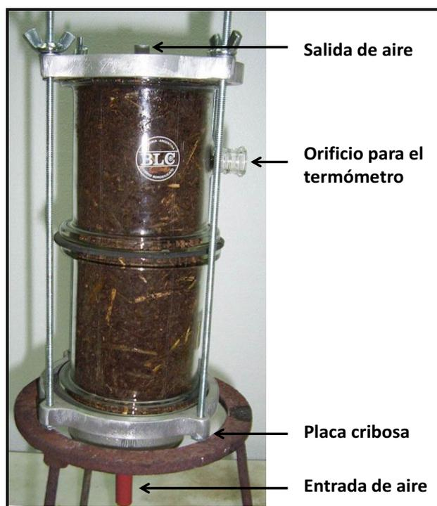
Figura II.9. Dispositivo donde se realizó el ensayo III de compostaje del suelo.
