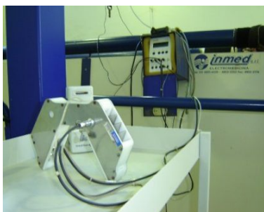
Foto 2.3. Sensor de flujo volumen acoplado a sistema Meta Vet.
