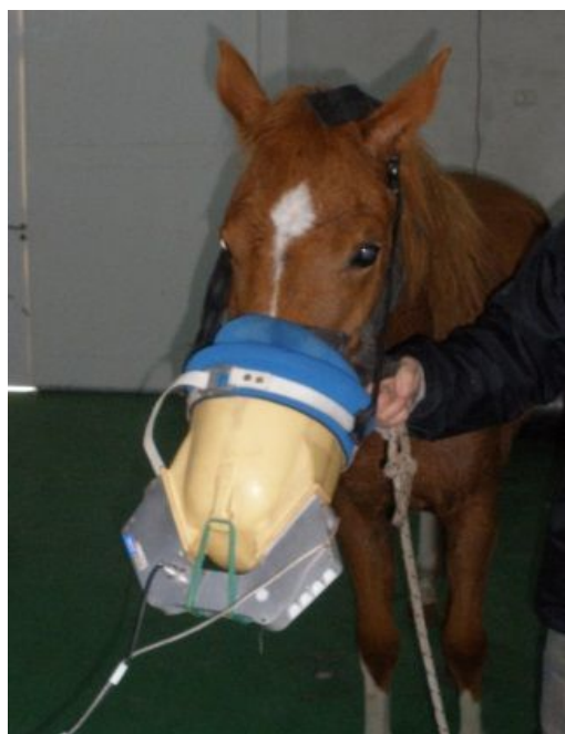
Foto 2.4. Sensor de flujo volumen acoplado la máscara nasal colocado en el animal, preparado para subir a la cinta.
