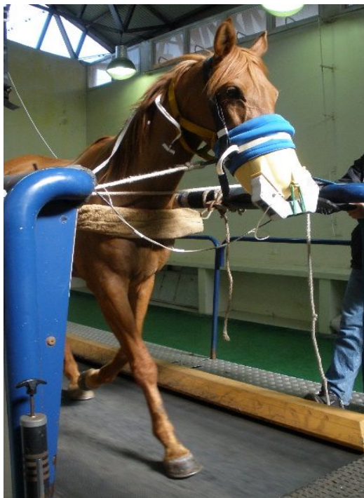
Foto 2.5. Sistema de ergo-espirometría en marcha con el equino sobre la cinta.
