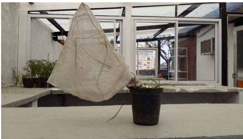
Figura IV.3. Jaulas de cuarentenas para detectar la presencia de parasitoides, armadas con bolsas de tela tipo voile, conteniendo plantas en su interior para la alimentación de los insectos.
