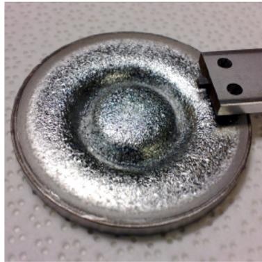
Figura 2.3: Blanco de hierro, utilizado en pulverización catódica con magnetrón [2].
