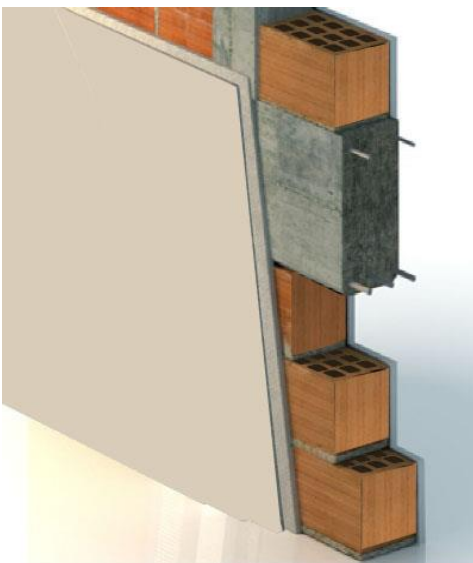
Ilustración 2 Corte perspectivo del sistema de muro utilizado
