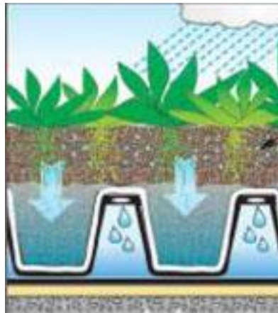
Ilustración 8 Esquema de funcionamiento del panel drenante
