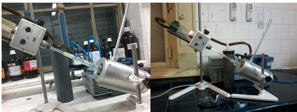
Figura 88. Equipo Kugelrohr.
