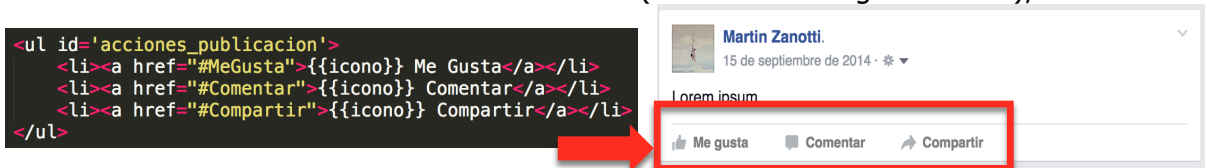
Figura 3.2.4.2: Ejemplo de código HTML que podría representar un conjunto de acciones en Facebook.
