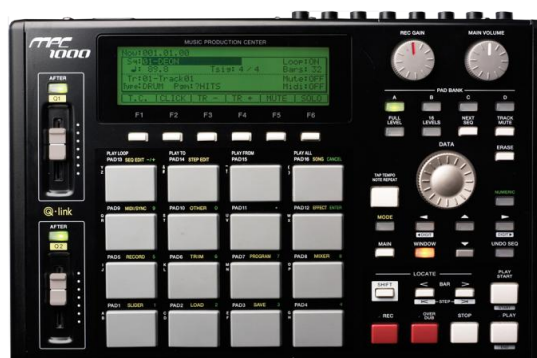
AKAI MPC 1000. Sampler de percusión con secuenciador. Uno de los tantos modelos de la serie MPC, fueron definitorios para la estética de los índices basados en samples de breakbeats. En color gris, la matriz de 16 pads sensitivos. 684
