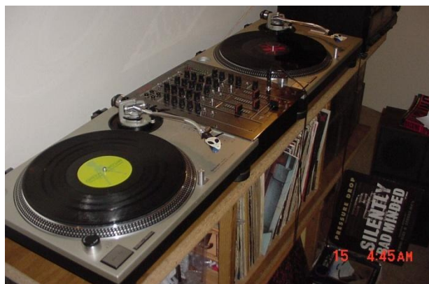
Configuración básica para discos de vinilo (sistema analógico). En la ilustración, dos legendarias bandejas Technics SL-1200 . 692
