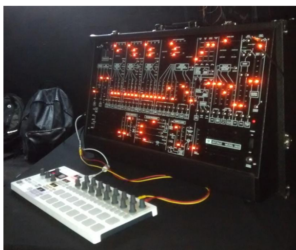
Antonius 2600 . Réplica del ARP 2600 fabricada por Antonio Gutierrez. Acompañado del secuenciador Arturia Beatstep , se muestra tal como se lo presentara durante el II Encuentro de Armado de Sintetizadores y otras demencias . Buenos Aires, julio 2016. 305
