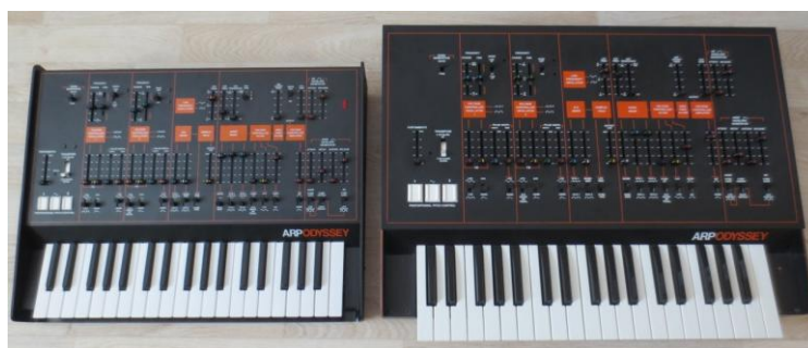
El sintetizador ARP Odyssey (der.) y la reedición de la firma Korg (izq.). Nótese la reducción de tamaño en la versión moderna.
