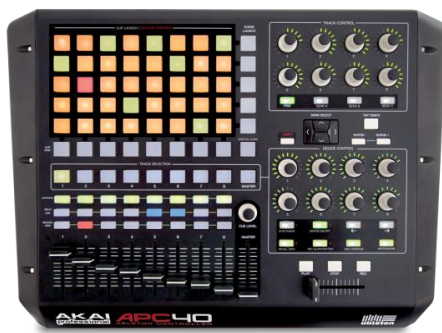
AKAI APC40 (izq.). Dispositivo físico especialmente diseñado para controlar al programa Ableton Live . JazzMutant Lemur y su versión software para Ipad (der.). Dispositivo de pantalla táctil genérico, con capacidad de control sobre diversos programas de computadora. 690
