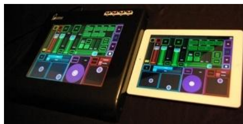
AKAI APC40 (izq.). Dispositivo físico especialmente diseñado para controlar al programa Ableton Live . JazzMutant Lemur y su versión software para Ipad (der.). Dispositivo de pantalla táctil genérico, con capacidad de control sobre diversos programas de computadora. 690
