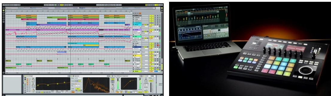
Una de las pantallas principales de Ableton Live (izq.) y el sistema Maschine de Native Instruments (der.). Complejos sistemas que en su raíz mantienen las lógicas de funcionamiento de los primitivos secuenciadores por pasos, el segundo también resulta un sampler de ritmos físico-virtual. 682
