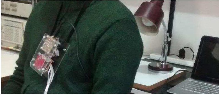
Figura 4.12: Uso del módulo con aislamiento y conexión USB a una computadora portátil.
