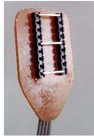
Figura 6.5: Fotografía del electrodo branched implementado, desde el lado de los contactos de electrodo.
