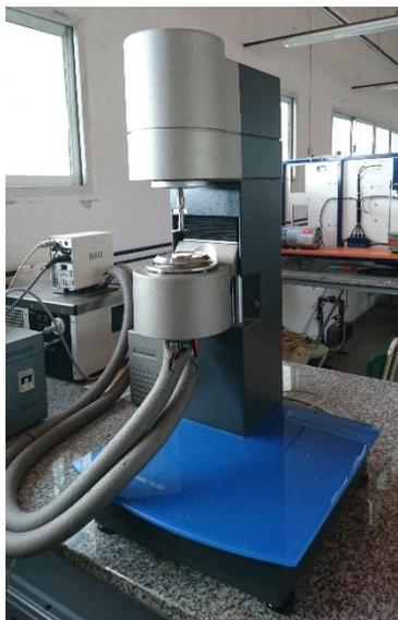
**Figura 2.3.** Reómetro oscilatorio Haake RS600 de esfuerzo controlado (ThermoElectron, Alemania)
