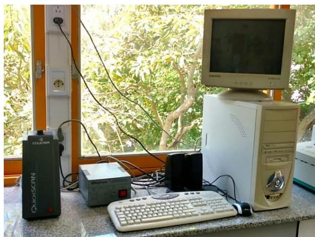
**Figura 2.4.** Analizador vertical de barrido Quickscan (Beckman Coulter, Fullerton, EEUU)
