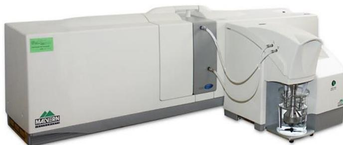
**Figura 2.1.** Analizador de tamaño de partículas Malvern Mastersizer (Malvern Instruments Ltd., Reino Unido)
