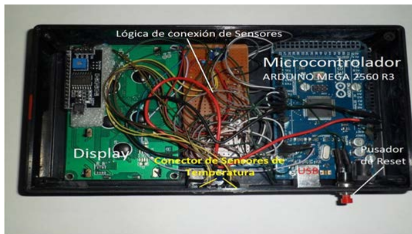
Figura 4 Vista interior del Sistema de Adquisición de datos, identificando cada bloque funcional
