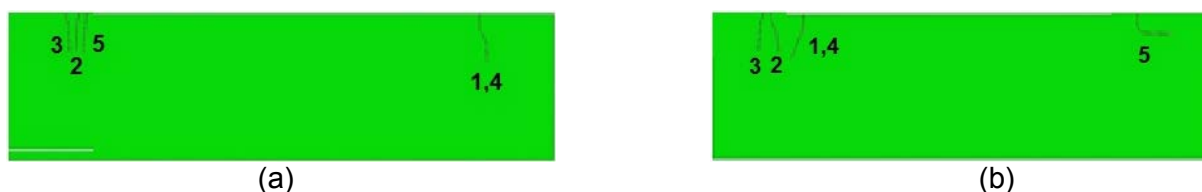
Figura 7. Patrones de fisuración en la base 8mx2m empotrada. El número de cada fisura corresponde al arreglo respectivo. (a) Distribución normal (b) Distribución de Weibull.
