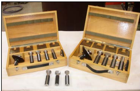
Foto 3. Calibres de la norma IEC 60120
