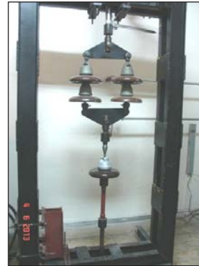
Foto 7. Aislador montado en la máquina de ensayo
