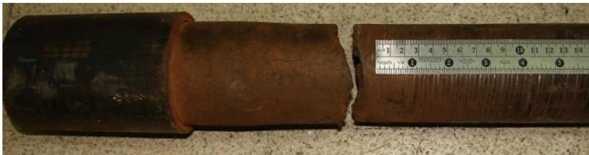
Figura 2. Extremo del tubing donde se produjo la fractura. Se aprecia una estricción del tubo en la región de fractura.
