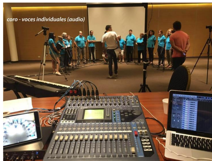
Fig. 5: Instalación de la situación experimental desde la consola de audio donde se observa la disposición de los elementos de captura y el registro de las voces en canales por separado.
