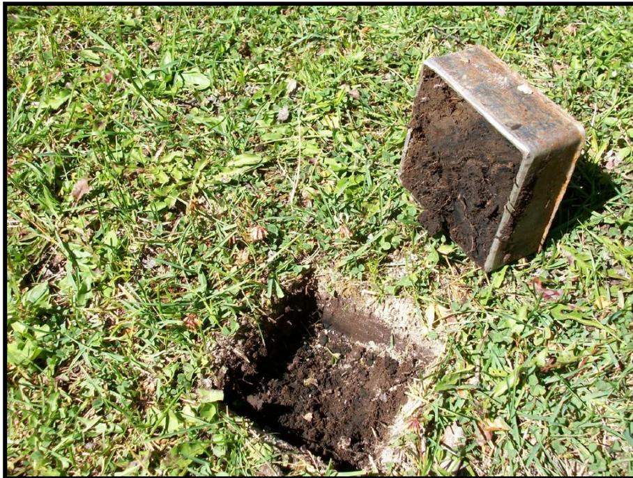
**Foto 3.4: Vista de muestreo mediante un sacabocado para artrópodos que habitan en el suelo.**
