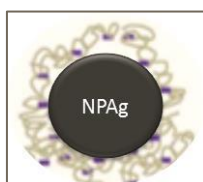
Figura V.11. Esquema de nanopartículas de plata estabilizadas por efectos estéricos
