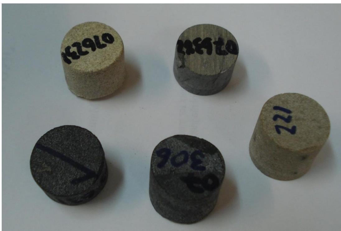
Figura 4.8: Muestras cortadas listas para medir.
