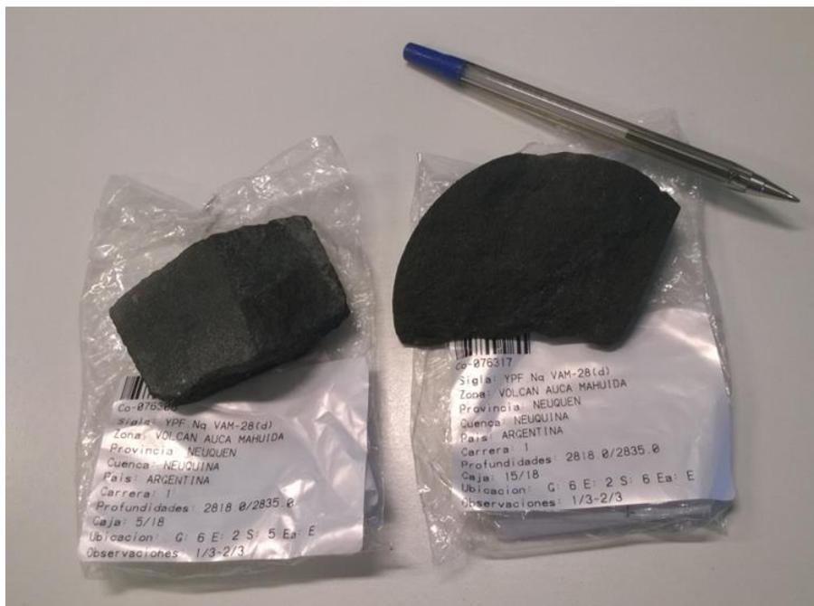
Figura 4.7. Fragmentos de diques basálticos atravesados por el pozo.
