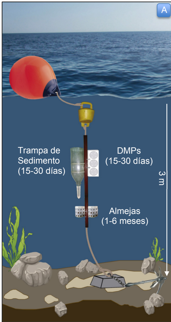
Figura 17. Diseño (A) y despliegue (B) de la boya de muestreo de matrices múltiples.
