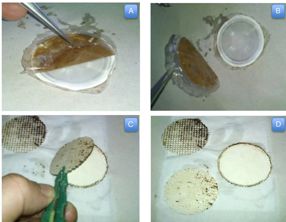
Figura 40. Extracción de las membranas difusoras de LDPE (A y B) y de AC (C y D) cubiertas con biofouling y micro-partículas después de un despliegue del DMP.
