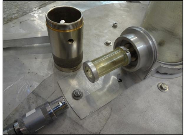
Foto 6 - Resistor de pie del divisor - desarmado
