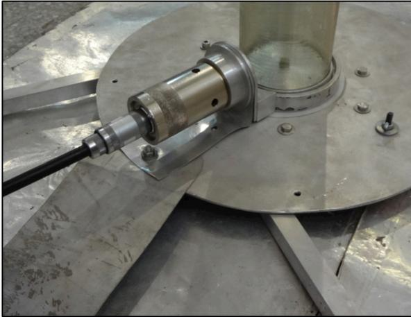
Foto 5 - Resistor de pie del divisor - armado
