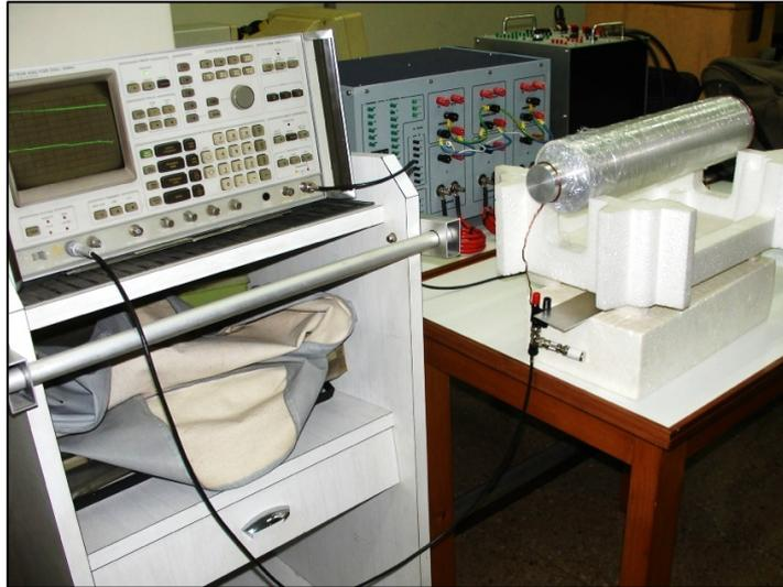
Foto 1 - Prueba de respuesta en frecuencia
