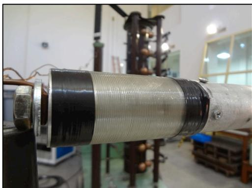
Foto 3 - Resistor de amortiguamiento
