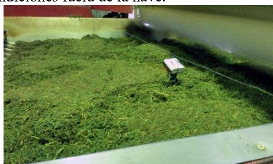
Figura 1. Cinta transportadora al final del proceso de enrollado y principio del proceso de fermentado. (Fotografía tomada en enero del 2015)
