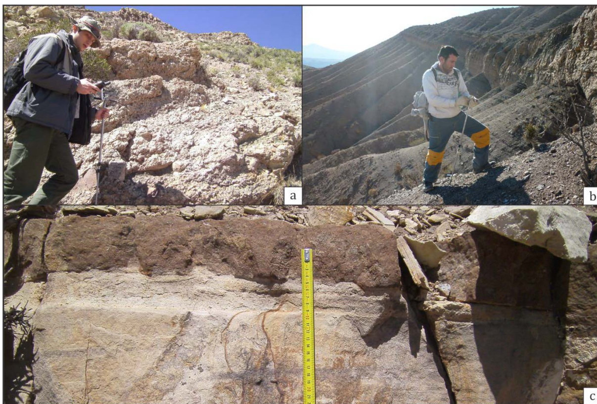
Fig. 3.3. Levantamiento de perfiles estratigráficos. a) Ubicación de las coordenadas y alturas de inicio y fin de los perfiles relevados. b) Levantamiento utilizando báculo de Jacob en unidades de gran espesor. c) Utilización de cinta métrica para la determinación de espesores en unidades con poco desarrollo.
