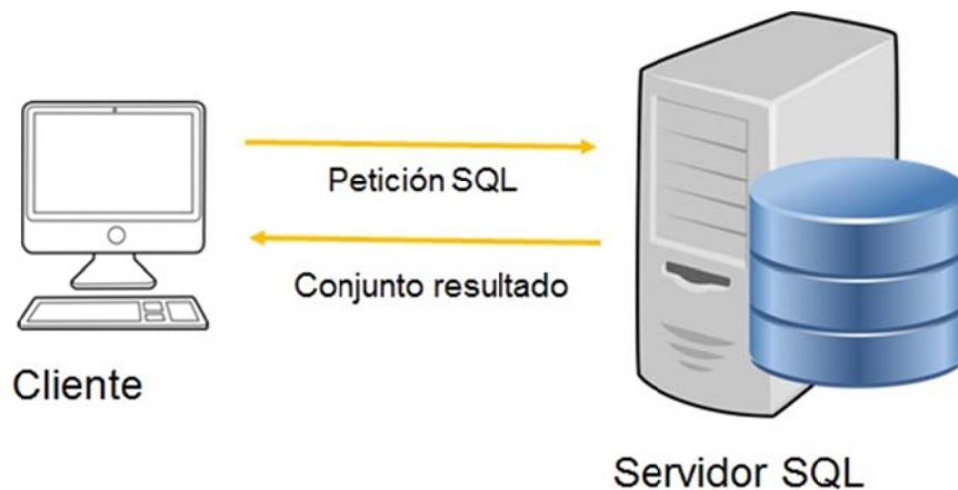
Fig. 47. Arquitectura Cliente/Servidor Clásico
