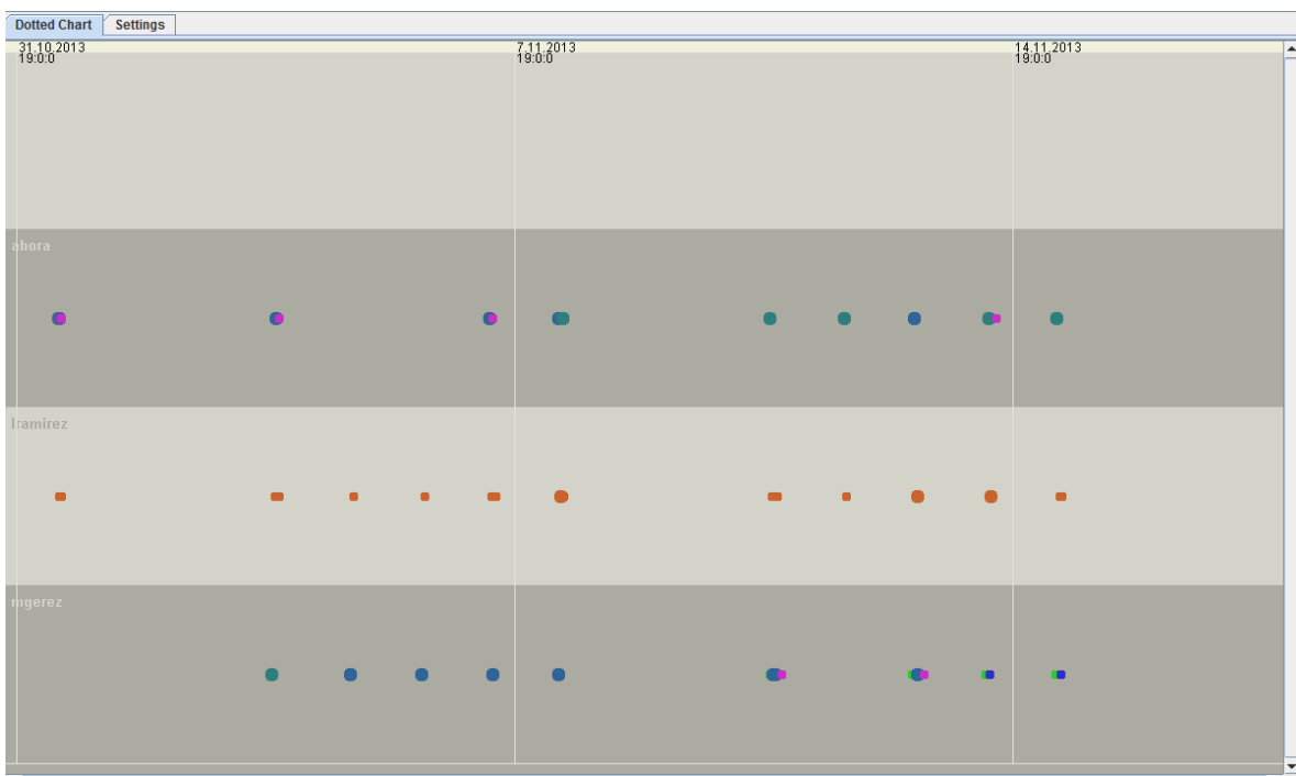
Figura 112 Dotted chart aplicado al proceso de solicitud de compra desplegado por participante
