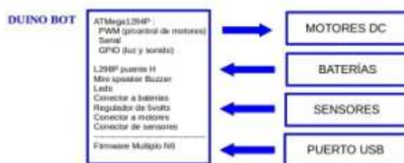
Figura 1: Esquema de la arquitectura del sistema Multiplo N6 Max.
