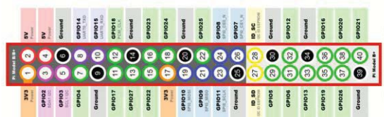
Figura 4. Salidas GPIO de Raspberry Pi.
