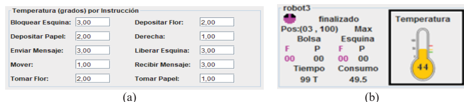
Fig. 3. ECMRE (a) Temperatura por instrucción en sección Robot/Procesador, (b) Información de Ejecución, donde se observa la temperatura del robot
