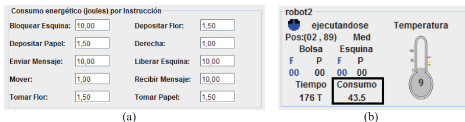
Fig. 2. ECMRE (a) Consumo energético por instrucción en sección Robot/Procesador, (b) Información de Ejecución, donde se observa el consumo energético del robot
