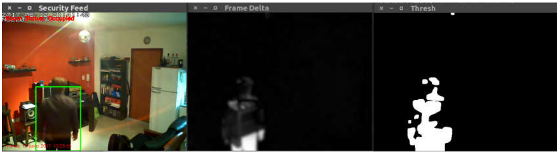
Imagen 2: Prueba de detección de movimiento, realizada sobre un stream de video, mediante la implementación mas básica de sustracción de fondo con OpenCV y Python (Fuente: propia)
