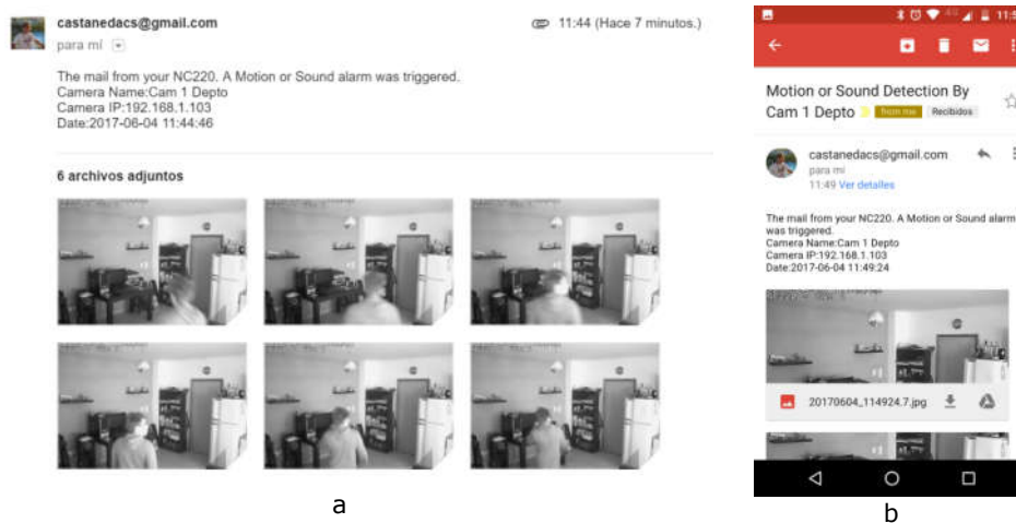
Imagen 33: Emails enviados por la cámara ante un evento de detección de movimiento o sonido. a) Email recibido en webmail b) el mismo email visualizado desde un teléfono móvil (Fuente: propia)
