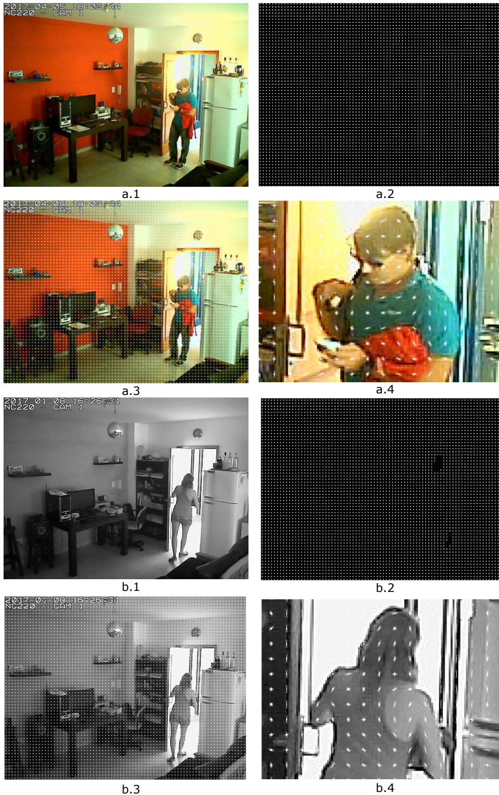
Imagen 3: Visualización de los descriptores de Histogramas de Gradientes Orientados en imágenes con personas utilizando Matlab a.1 b.1) Imagen original a.2 b.2) Gradientes Orientados de la imagen original a.3 b.3) Superposición de los gradientes sobre la imagen original a.4 b.4) Detalle de la orientación de los gradientes en la zona donde se visualiza una persona (Fuente: propia)
