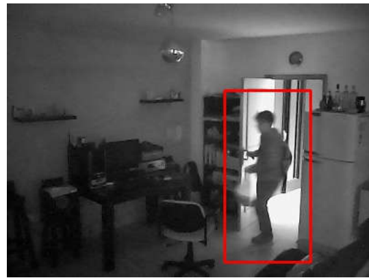
Imagen 9: Prueba de detección de personas con HOG + LSVM en OpenCV, sobre imágenes capturadas con la cámara utilizada en este informe (Fuente: propia)
