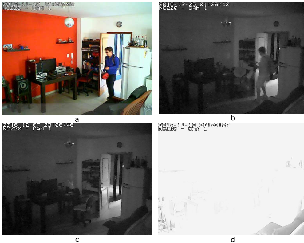
Imagen 36: Ejemplos de verdaderos positivos registrados por la cámara al detectar movimiento en el área monitoreada a) Presencia de personas (muestra tomada con la cámara en modo diurno) b) Presencia de personas (muestra tomada con la cámara en modo nocturno) c) Movimiento real de objetos (apertura de la puerta) d) Cambio de la luz artificial del área monitoreada (Fuente: propia)
