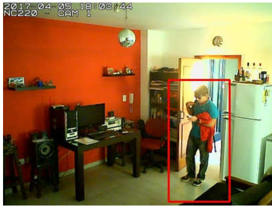
Imagen 9: Prueba de detección de personas con HOG + LSVM en OpenCV, sobre imágenes capturadas con la cámara utilizada en este informe (Fuente: propia)
