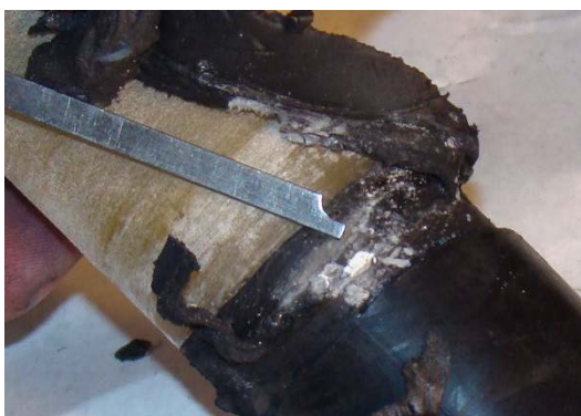
Fig. 18. Material carbonizado y cenizas entre la masilla y la semiconductor externa
