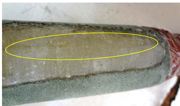
Fig. 19. Marca longitudinal sobre el aislamiento principal
