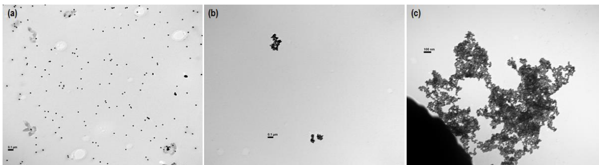
Figura 7.6. Imágenes TEM de campo claro para (a) Au(32) (b) Au(32)@Si y (c) Au(32)@paSi.
