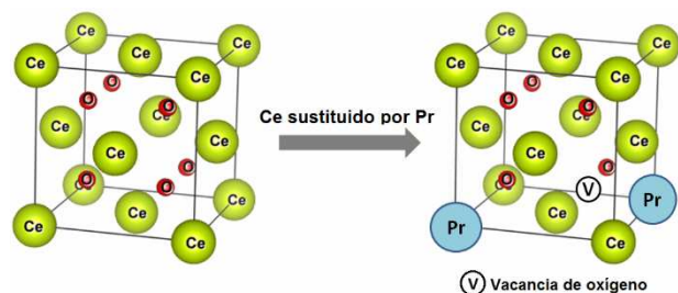
Figura 3. Celda unitaria de \text{CeO}_2 y la variación de la celda unitaria durante el proceso de dopaje (Elaboración propia utilizando el software VESTA).
