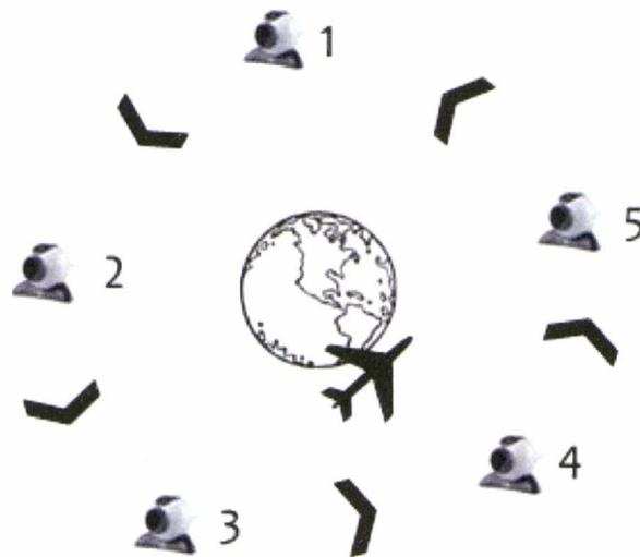
Figura 3.4. En el esquema manual, las cámaras cambian secuencialmente, similar a una arquitectura token ring.
