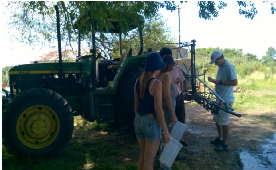
Figura 2. Medición del caudal de pastilla con jarras manuales graduadas
