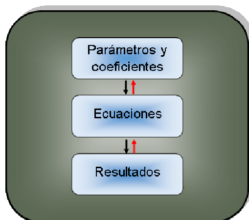
Figura 1: Etapas de la resolución directa (líneas negras) e inversa (líneas rojas) del problema asociado a la caracterización térmica de un edificio.
