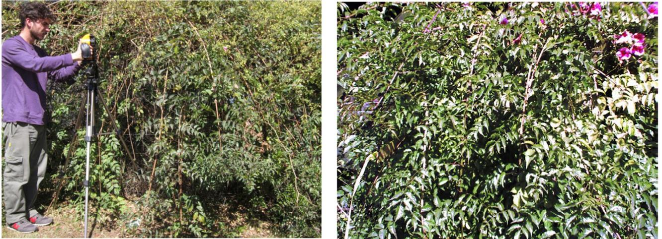
*Figura 1: Izquierda: montaje experimental para medición termográfica del perfil de la enredadera en un día de finales de julio. Derecha: vista de frente de la bignonia en los primeros días de mediciones. Puede notarse un sutil cambio en el color de las hojas y la densidad del follaje entre ambas fotos.*
