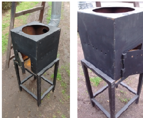
Figura 6: Vistas de la cocina con la nueva entrada de aire distribuida en los laterales y al frente de la puerta.
