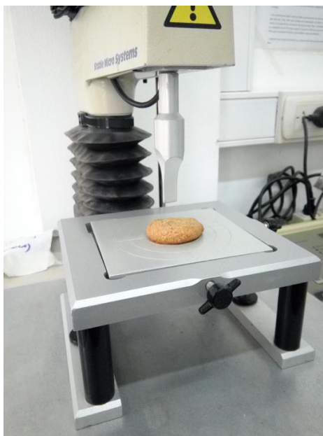
Figura III.5. Sonda Volodkevich Bite Jaws utilizada en el ensayo de textura de compresión de las galletitas.
