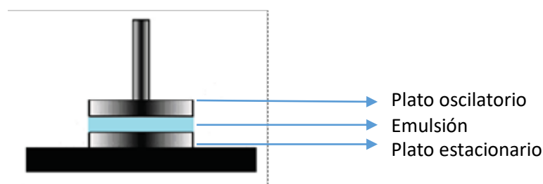
Figura I.8. Esquema de un sistema de platos paralelos (Fuente: Adaptado de Steffe, 1996).
