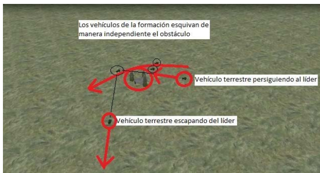
Fig.2 Vehículos terrestres rompen temporalmente la formación mientras evaden un obstáculo, siguiendo una ruta predefinida. Otro par de vehículos está en modo persecución y evasión respectivamente.
