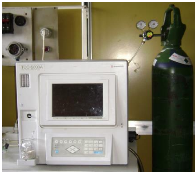
Figura 3: Equipo de medición de carbono orgánico
