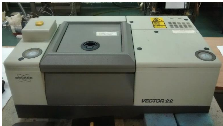
Figura 65: Equipo utilizado para las lecturas de FTIR
