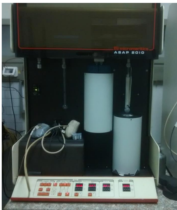
Figura 62: Equipo utilizado para las medidas de adsorción de N 2 a 77 K.
