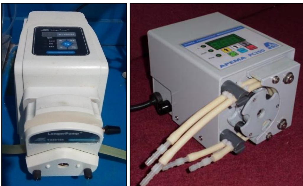
Figura 41: Detalle de las bombas peristálticas utilizadas. A la izquierda se muestra la bomba 1 y a la derecha la bomba 2.
