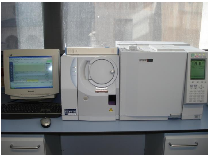
Figura 4: Cromatógrafo de gases con espectrómetro de masas
