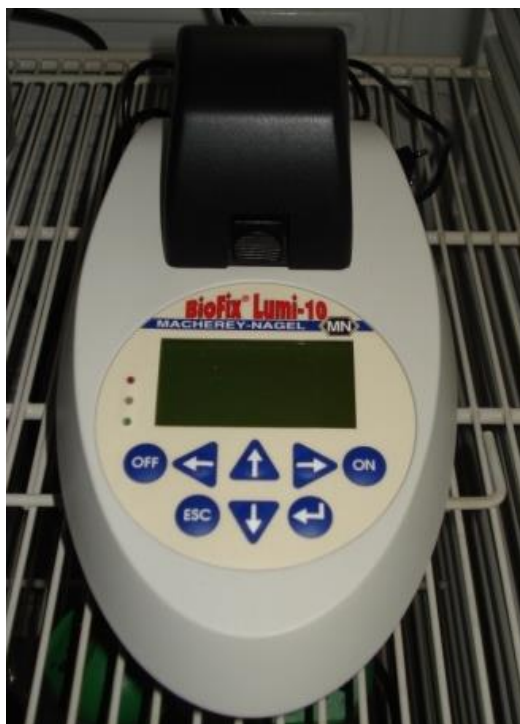
Figura 5: Luminómetro utilizado para las medidas de toxicidad
