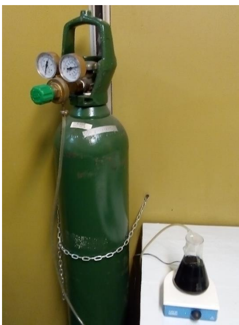
Figura 7: Sistema utilizado para las cinéticas ZVI/ \text{N}_2 .
