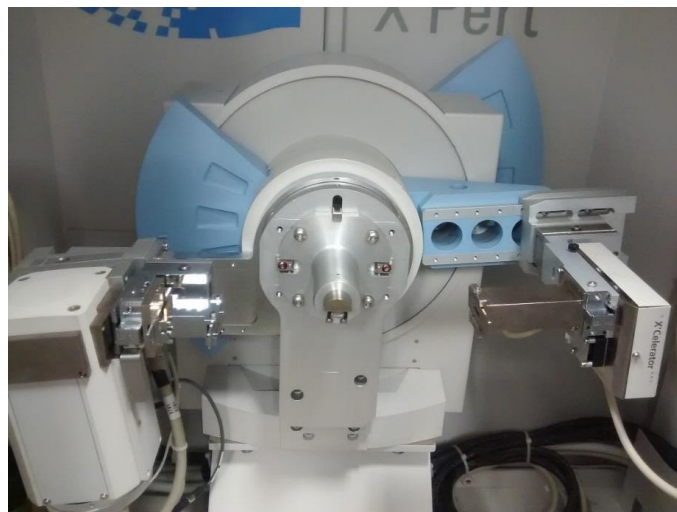
Figura 64: Equipo utilizado para las medidas de DRX.
